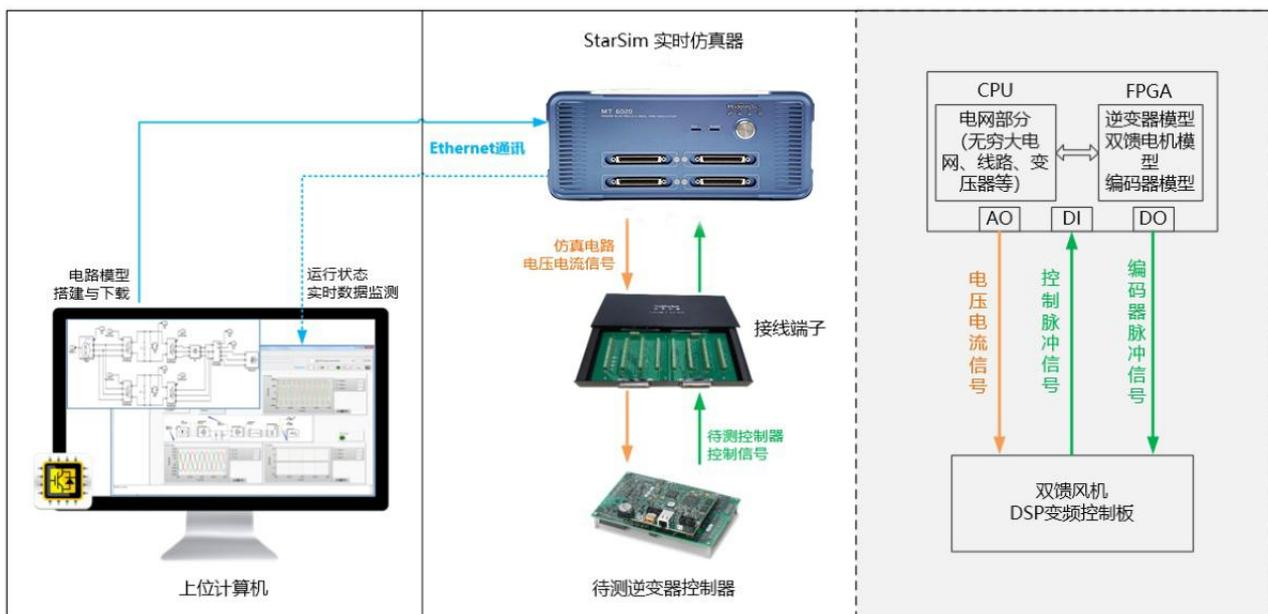
上图为基于半实物仿真的系统示意，用户可利用 StarSim HIL 软件载入自己搭建的风力发电以及电网部分的模型，并与变流器控制器通过物理接线闭环运行。可以在模型中方便地改变网侧的跌落值、持续时间，进行反复的实验与验证。
