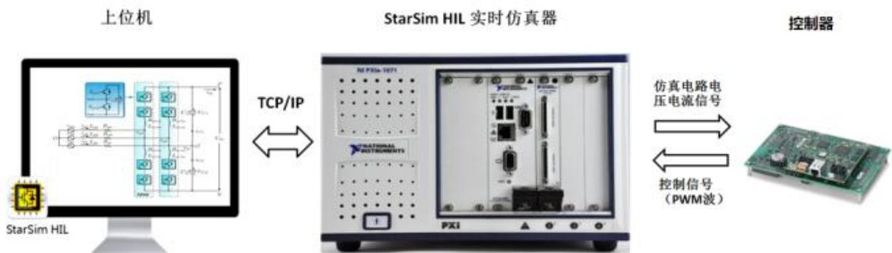
1——控制器，用于实现验证实验中需要用到的控制算法，发出控制信号给实时仿真器，构成闭环的实验系统，为客户自己的实物控制器。
