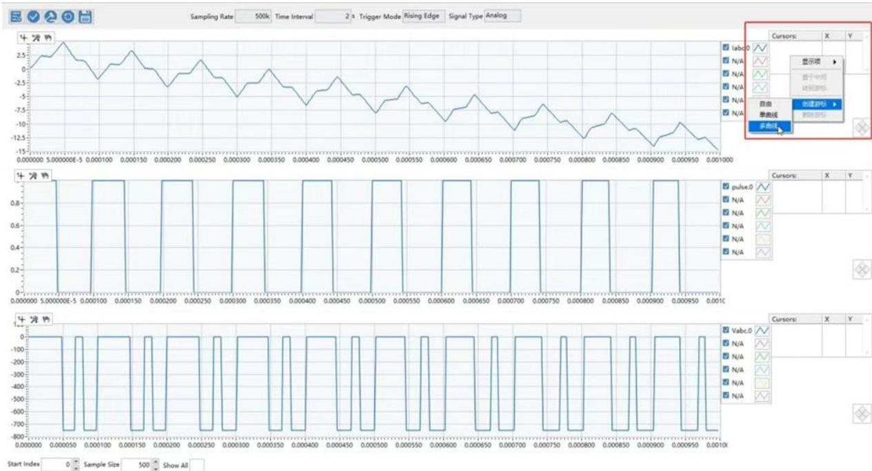
在控制代码开发的过程中往往需要对一些控制参数进行诊定,使用半实物仿真验证时即使参数不具有鲁棒性也不会导致硬件设备的损坏,极大的提高了实验的安全性和经济性。并且实验过程中的波形数据可以记录回放,便于后期整理对比不同参数的实验结果,加快了功能的验证。
