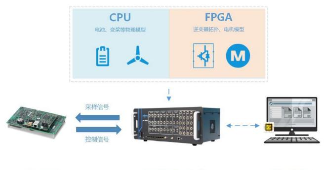
用户控制板 MT 6040实时仿真器 HIL上位机软件
